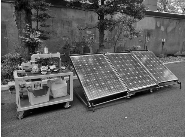
図9 太陽光駆動型ビーズ MDEL を用いた連続水殺菌装置
