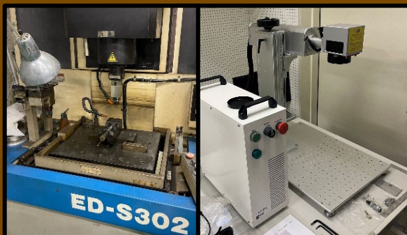
CFD解析によるテクスチャ最適化 放電工・レーザー加工
